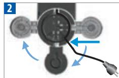
Je nachdem ob Sie den Wassertank links oder rechts positionieren möchten, führen Sie das Kabel in die Führung links oder rechts unter dem Wassertankanschluss ein und stellen Sie das Gerät aufrecht hin.
