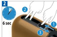
Öffnen Sie den Schieber des Kapselfachs. Berühren Sie 6 Sekunden lang gleichzeitig die Lungo- und Ristrettotaste. Die Espressotaste blinkt zur Bestätigung. Schliessen Sie den Schieber des Kapselfachs um den Entleerungsvorgang zu starten.
