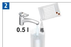
Remplissez le réservoir d'eau de 0,5 l d'eau et ajoutez le liquide de détartrage Nespresso.
