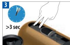
Wenn Sie die automatische Abschaltung auf 30 Minuten verlängern möchten, schließen Sie vorab den Schieber des Kapselfachs. Anschließend berühren Sie die Lungo- und Ristrettotaste für min. 3 Sekunden. Die Espressotaste blinkt einmal zur Bestätigung. Um die automatische Abschaltung auf 9 Minuten zurück zu stellen, wiederholen Sie den Vorgang. Die Espressotaste blinkt dreimal zur Bestätigung.
