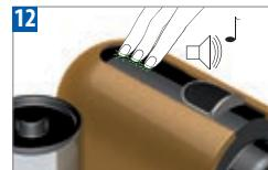
Um den Entkalkungsmodus zu verlassen, berühren Sie mind. 3 Sekunden lang gleichzeitig alle drei Soft-Touch-Tasten. Ein Kontrollgeräusch bestätigt den Moduswechsel. Das Gerät kann jetzt benutzt werden.
