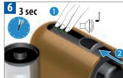
Pour enclencher le détartrage, après avoir verrouillé la fermeture coulissante, appuyez en même temps sur les 3 boutons de commande pendant au moins 3 secondes. Un court signal sonore confirmera l'enclenchement. Les boutons de commande se mettront à clignoter rapidement.
