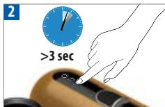
La machine peut être mise en mode Arrêt à tout moment. Fenêtre coulissante fermée, maintenez appuyé un bouton pendant plus de 3 secondes, jusqu'à ce que les autres 2 boutons clignotent. The machine can be turned into OFF mode at any time when slider is closed by pushing any control for more than 3 sec., confirmed by the other 2 controls flashing.
