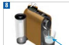
Stellen Sie ein Gefäß unter den Kaffeearauslauf. Berühren Sie die Lungotaste. Schließen Sie den Schieber, um das Gerät zu spülen. Wiederholen Sie den Vorgang dreimal. *Posizionare un contenitore sotto l'erogatore di caffè. Premere il pulsante Lungo. Chiudere la finestra scorrevole per sciacquare la macchina. Terminato il processo riaprire la finestra scorrevole. Ripetere 3 volte.*
