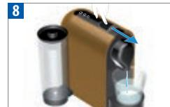
Schließen Sie den Schieber um den Entkalkungsvorgang zu starten. Das Gerät stoppt, wenn der Wassertank leer ist.
