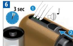
Um in den Entkalkungsmodus zu wechseln, berühren Sie bei geschlossenem Schieber 3 Sekunden lang alle 3 Soft-Touch-Tasten gleichzeitig. Zur Bestätigung erklingt ein Piepton. Öffnen Sie den Schieber.
