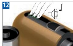
Pour quitter le mode détartrage, appuyez sur les 3 boutons en même temps pendant au moins 3 secondes. La machine émet un bip sonore pour confirmer l'opération. La machine est maintenant prête à l'emploi.
