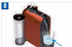
Coloque un recipiente debajo de la salida del café. Pulse el botón Lungo. Cierre el deslizante para aclarar la máquina. Repítalo tres veces.
