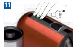
Para salir del modo de descalcificación pulse los tres botones simultáneamente durante más de 3 s. Un sonido breve confirmará esta acción. La máquina está preparada para ser utilizada. Para sair do modo de descalcificação, pressione as 3 teclas simultâneamente durante mais de 3 segundos. Um pequeno som irá confirmar essa operação. A máquina está pronta para utilização.
