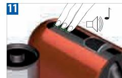
Kireç çözme modundan çıkmak için 3 dokunmatik tuş aynı anda 3 saniyeden fazla süre basılı tutun. Kısa bir sesli onay duyulacaktır. Makine kullanıma hazır. Для выхода из режима удаления накипи нажмите все три кнопки одновременно и удерживайте их в течение не менее 3-x секунд. Раздастся короткий звуковой сигнал. Теперь кофе-машина готова к использованию.
