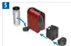
Coloque el depósito de agua en su brazo. Queda fijado con imanes. Introduzca la bandeja antigoteo y el contenedor de cápsulas usadas en su posición. Para su seguridad, utilice la máquina solo cuando la bandeja antigoteo y el contenedor de cápsulas usadas estén en su posición.
