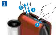
Sürgü kapağı kapatırken dokunmatik tuşu basılı tutun. İstenilen hacime ulaşıldığında bırakın. Diğer 2 dokunmatik tuşun ışığı yanacaktır. Su hacim seviyesi programlama için kullanılan tuşa kaydedilmiş olur.
