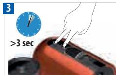
For at ændre den automatiske OFF mode fra 9 til 30 minutter, trykkes på både Lungo- og Ristretto-knapperne i mere end 3 sekunder med håndtaget lukket. Espresso-knappen blinker 1 gang. Gentag samme procedure for at vende tilbage til 9 minutter. Espresso-knappen blinker 3 gange.
