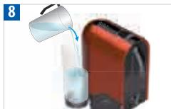
Su tankını kapta biriken kullanılmış kireç çözme sıvısı ile tekrar doldurun ve işlemi tekrar etmek için dokunmatik tuşlardan herhangi birini seçin. Снова наполните резервуар для воды используя раствором для удаления накипи, собранным в емкость, и Нажмите дважды кнопку, чтобы повторить процедуру.
