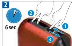
Sürgü kapağı açın. Ristretto ve Lungo dokunmatik tuşlarına birlikte basarak 6 saniye boyunca basılı tutun. Onay amaçlı diğer kontrol ışığı yanar. Sonrasında, işleme başlamak için sürgü kapağı kapatılabilirsiniz.
