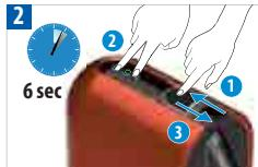
Abra el deslizador. Mantenga pulsados durante más de 6 s los botones Ristretto y Lungo simultáneamente. El otro botón se iluminará. A continuación, cierre el deslizador para iniciar el proceso. Abra o deslizante. Pressione e mantenha pressionadas durante 6 segundos as teclas Ristretto e Lungo em simultâneo. A outra tecla irá piscar. Feche o deslizante para iniciar procedimento.
