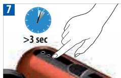
Du kan nå som helst slukke for maskinen, ved at trykke på en knap i mere end 3 sek., dette bekræftes ved at de to andre knapper blinker.
