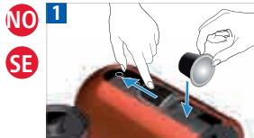
Alle knappene kan programmeres. Åpne skyvestykke og sett inn en Nespresso-kapsel.
