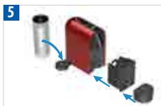
Su tankını yuvasına yerleştirin, mıknatıslar sayesinde yerine oturacaktır. Damlama tepsisi ve kullanılmış kapsül kabını yerine yerleştirin. Güvenliğiniz için makineyi damlama tepsisi ve kullanılmış kapsül kabı yerine yerleştirmeden kullanmayınız.
