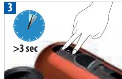
Slik endrer du automatisk deaktivering (AV-modus) fra ni til 30 minutter: Hold skyvestykket lukket, trykk og hold både Lungo- och Ristretto-knappene inne i mer enn tre sekunder. Espresso-knappen blinker én gång. För å gå tillbake til ni minutter er det bare å gjenta denne prosedyren. Espresso-knappen blinker tre ganger.
